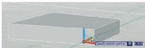
obr. 5: Okamžitá modifikace tělesa potlačením a táhnutím ploch a hran
